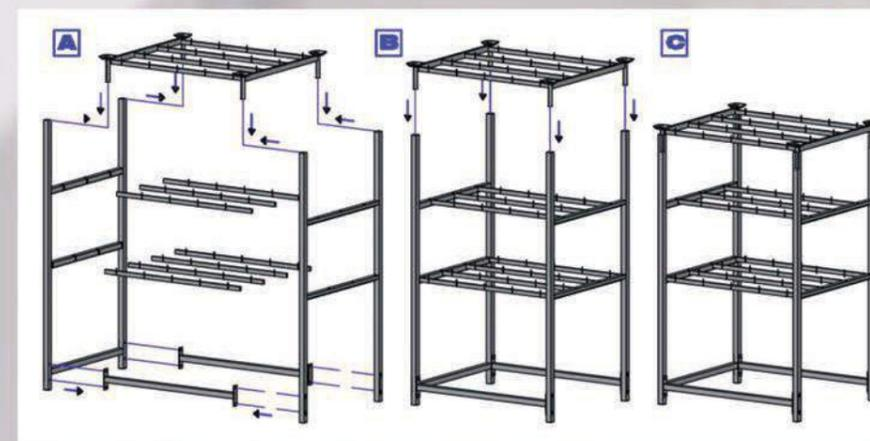
\* Montaje de un palet de jamones desmontable
