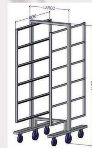
Carro para el transporte y secado de embutidos. **Carro para hornos**. Fabricado en acero inoxidable AISI 304.
