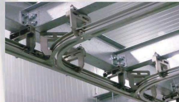
La red es de tipo **DOBLE VÍA**, formada por 2 perfiles de aleación de aluminio 6065-T3, separados 18-20mm.
