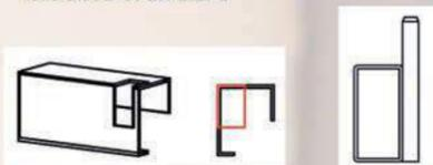
\* Encaje de barra en chapa cajeadada barra con gancho-varilla lateral
