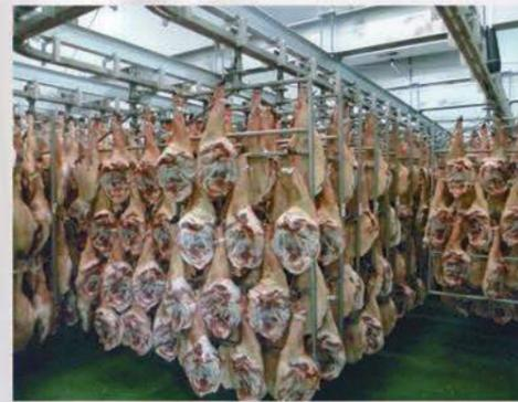
Producto diseñado para el transporte aéreo de cargas y de manera especial, pensada para el transporte y almacenamiento de productos cárnicos en todas sus fases: faenado, fresco, curado y almacenamiento de forma rápida, higiénica, segura y productiva. Se trata de instalaciones modulares totalmente adaptables a cualquier situación y de circulación ligera y silenciosa.
