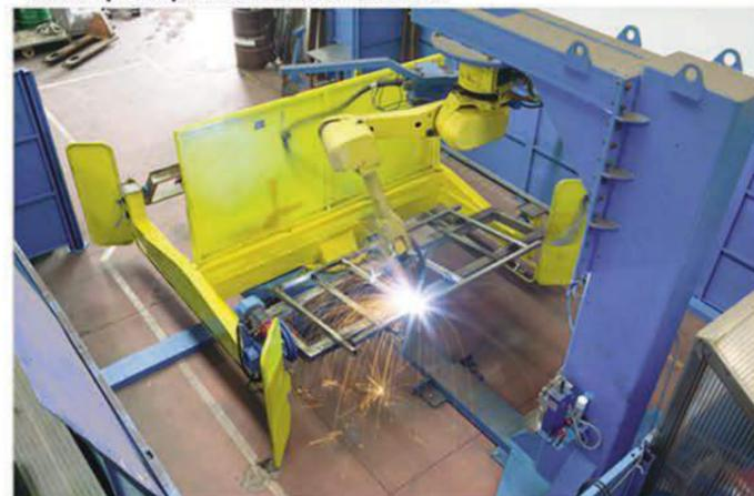
\* **Robot para fabricación de palets y estructuras en cadena.**
