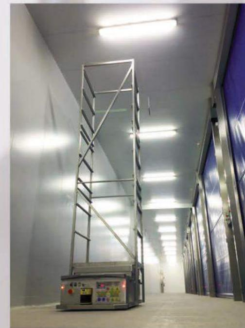
\* Robot desplazando estructura de embutidos vacía
