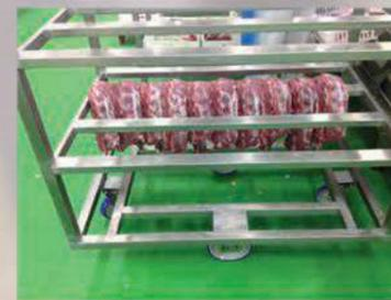
Carro para transporte de lomos, EN PERFILES, lomos doblados. Capacidad aproximada: 160 lomos. Tren basculante 4 ruedas. Fabricado en acero inoxidable AISI 304.
