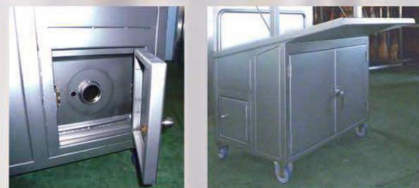
Equipo destinado a la industria cárnica, para el proceso de higienizado y protección frente a parásitos de jamones y paletas, mediante tratamiento por inmersión del producto en manteca caliente. La aplicadora de manteca permite al usuario seleccionar la temperatura de aplicación de la misma y mantenerla durante el proceso. El carrusel de escurrido facilita el trabajo de limpieza.
