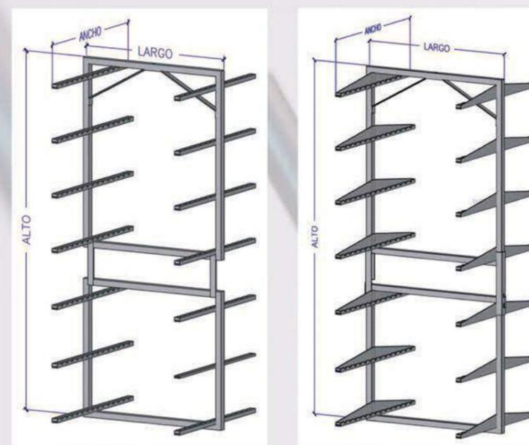
Perchas para el transporte y secado de embutidos. Fabricadas en acero inoxidable AISI 304.
