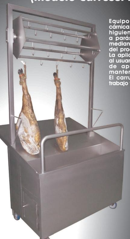
Equipo destinado a la industria cárnica, para el proceso de higuienizado y protección frente a parásitos de jamones y paletas, mediante tratamiento por inmersión del producto en manteca caliente. La aplicadora de manteca permite al usuario seleccionar la temperatura de aplicación de la misma y mantenerla durante el proceso. El carrusel de escurrido facilita el trabajo y la limpieza.
