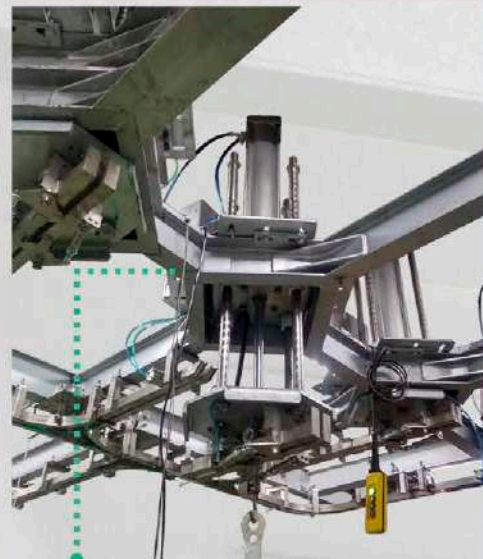
Elevador neumático, indicado para la elevación de perchas a través de cilindro neumático.
