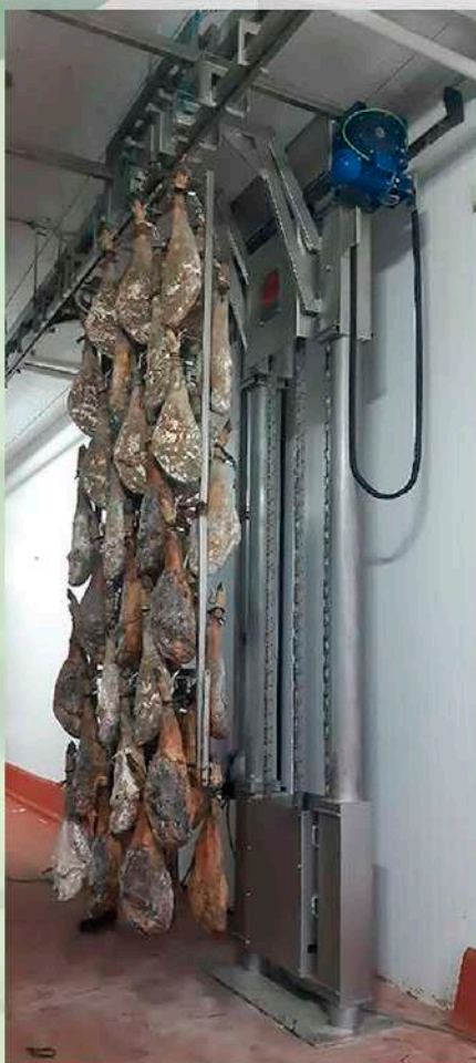
Elevador neumático, indicado para la elevación de perchas a través de cilindro neumático.
