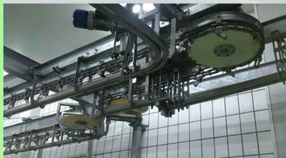
Transportador de cadena indicado para elevación de canales
